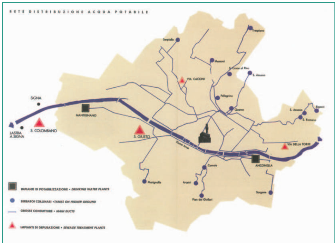
Fig. 16 - La rete di distribuzione dell'acqua potabile - fonte: archivio Publicacqua
